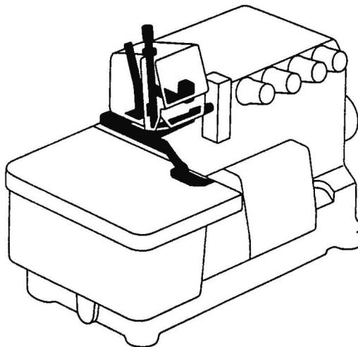
U. 押工関係/Presser foot mechanism/Стрека механизм
