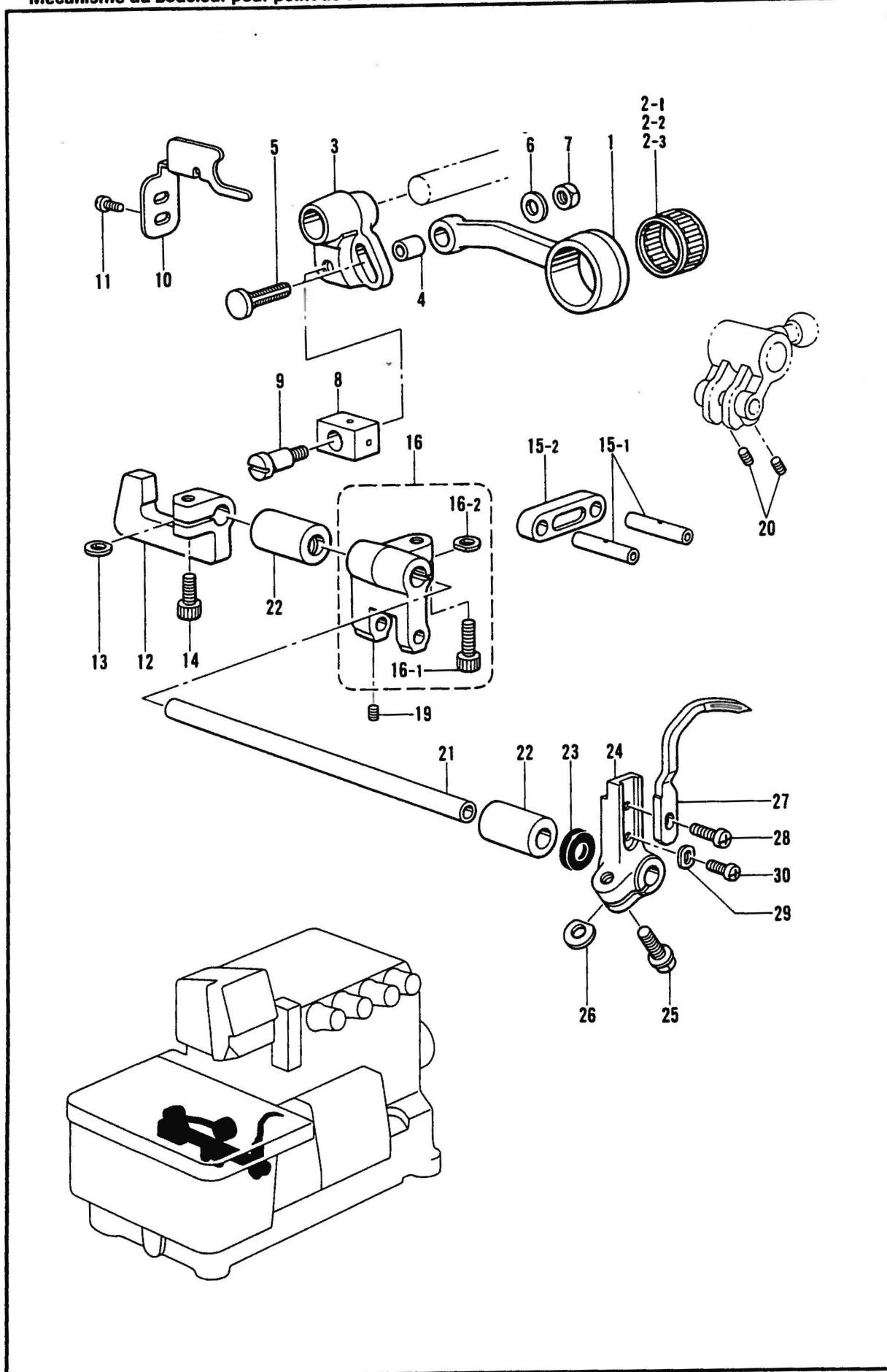
セーフティーリー / 実際 / Double Chain Stich Looper Mechanism / Mecanismo del presilladora de doble cadeneta
