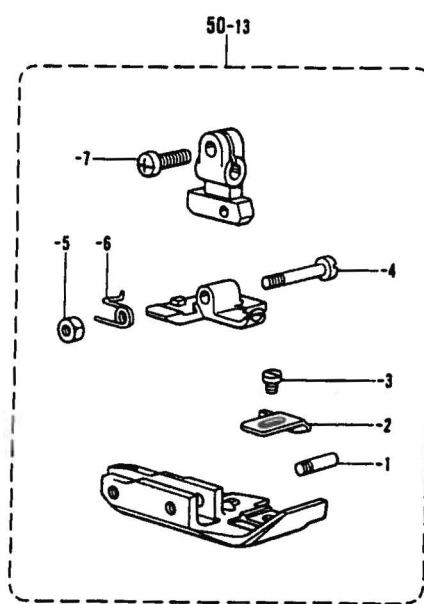
D. 振工関係/Presser foot mechanism/Stoffdruckfuß/
