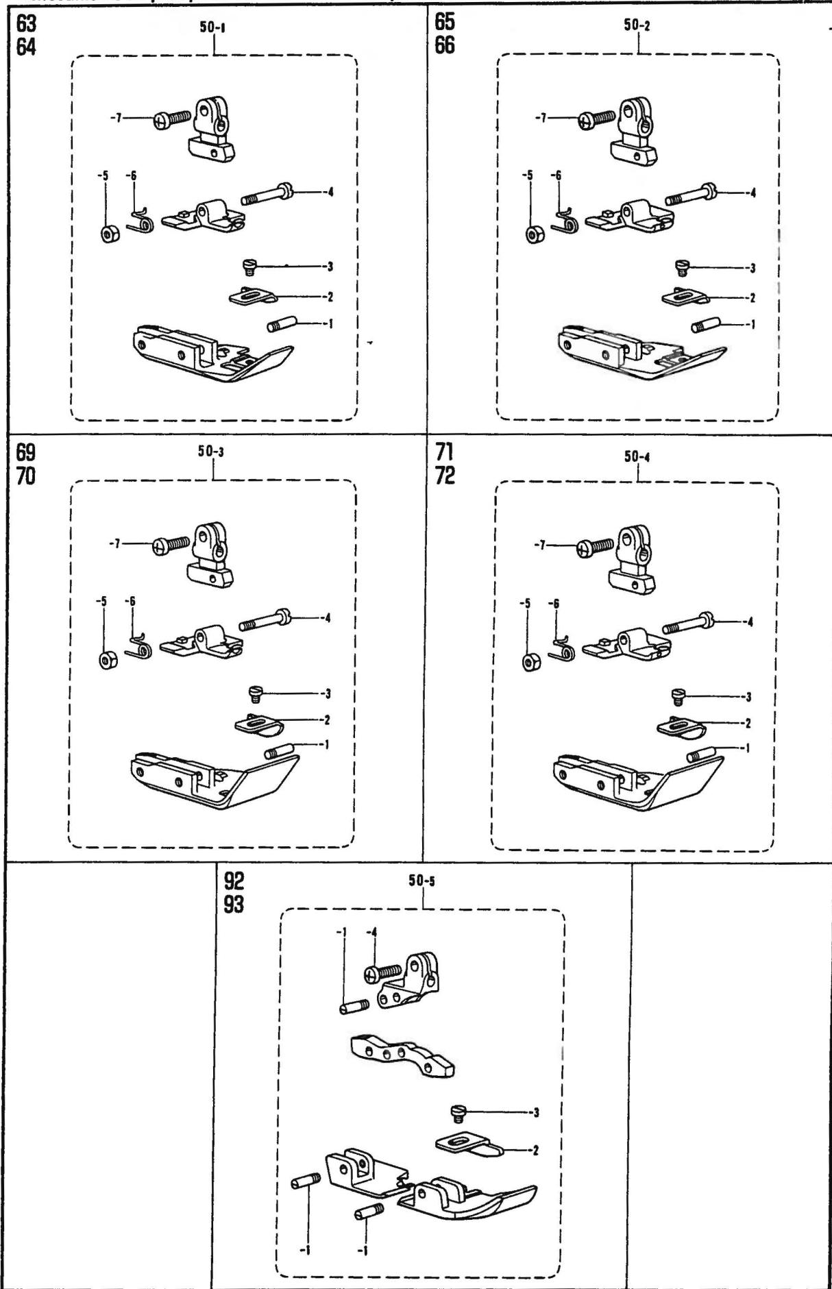
レ. 壓工脚部 / PRESSER FOOT MECHANISM / MÉCANISME DU PIED PRESSEUR / Mecanismo del prensa telas
