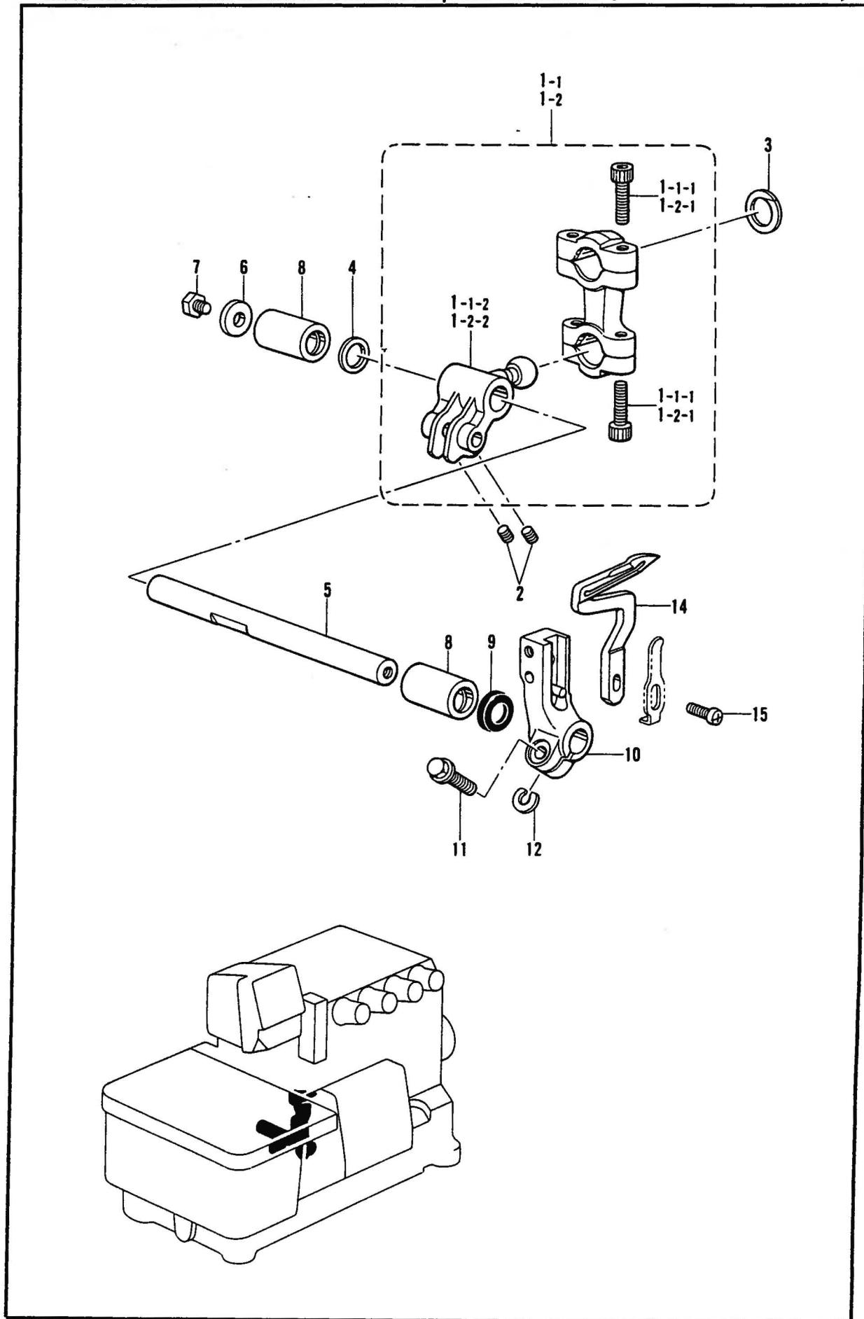
II. トグルハーフメカニズム / Under looper mechanism / Unterer Greiter /
