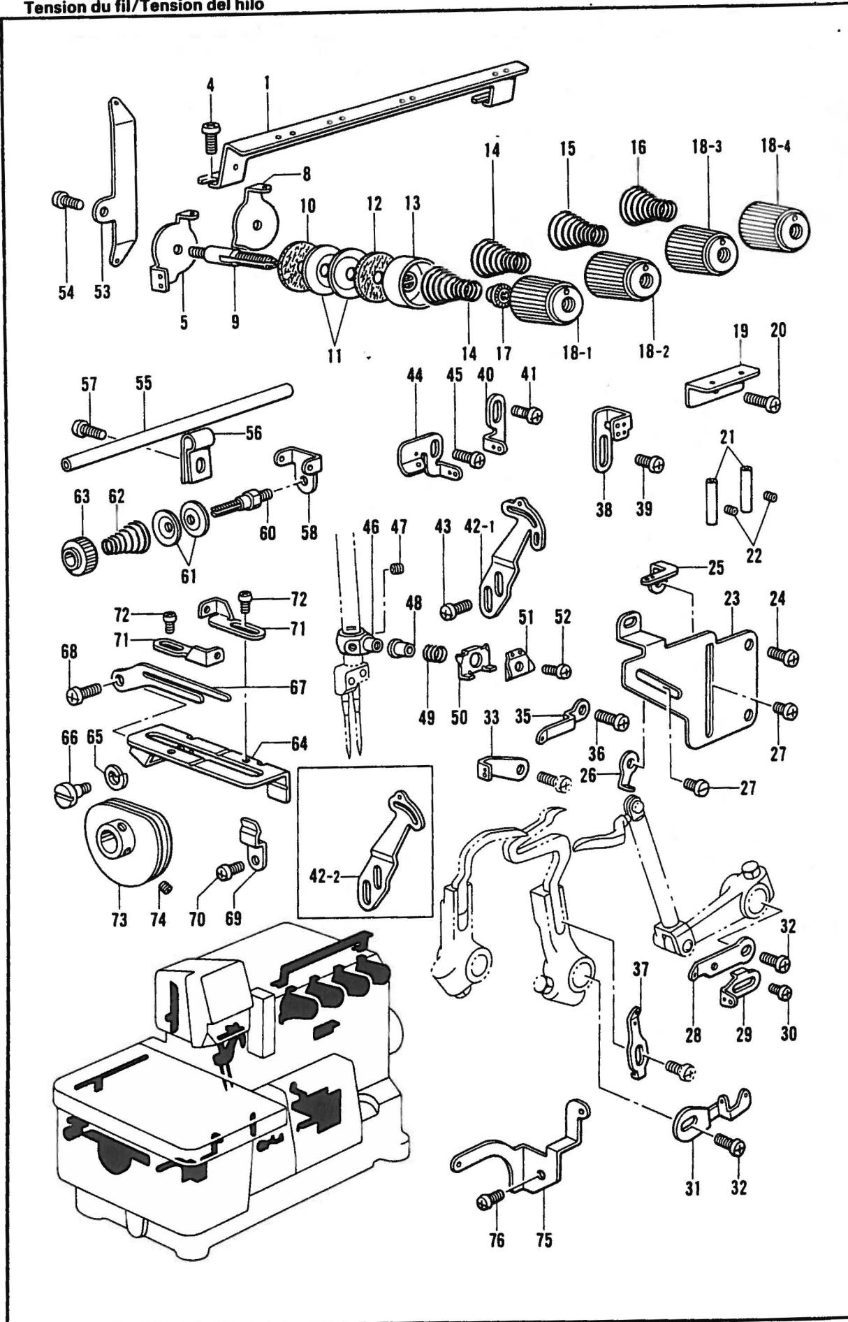
L. ホ調子関係 / Thread tension / Fadenspannung /
