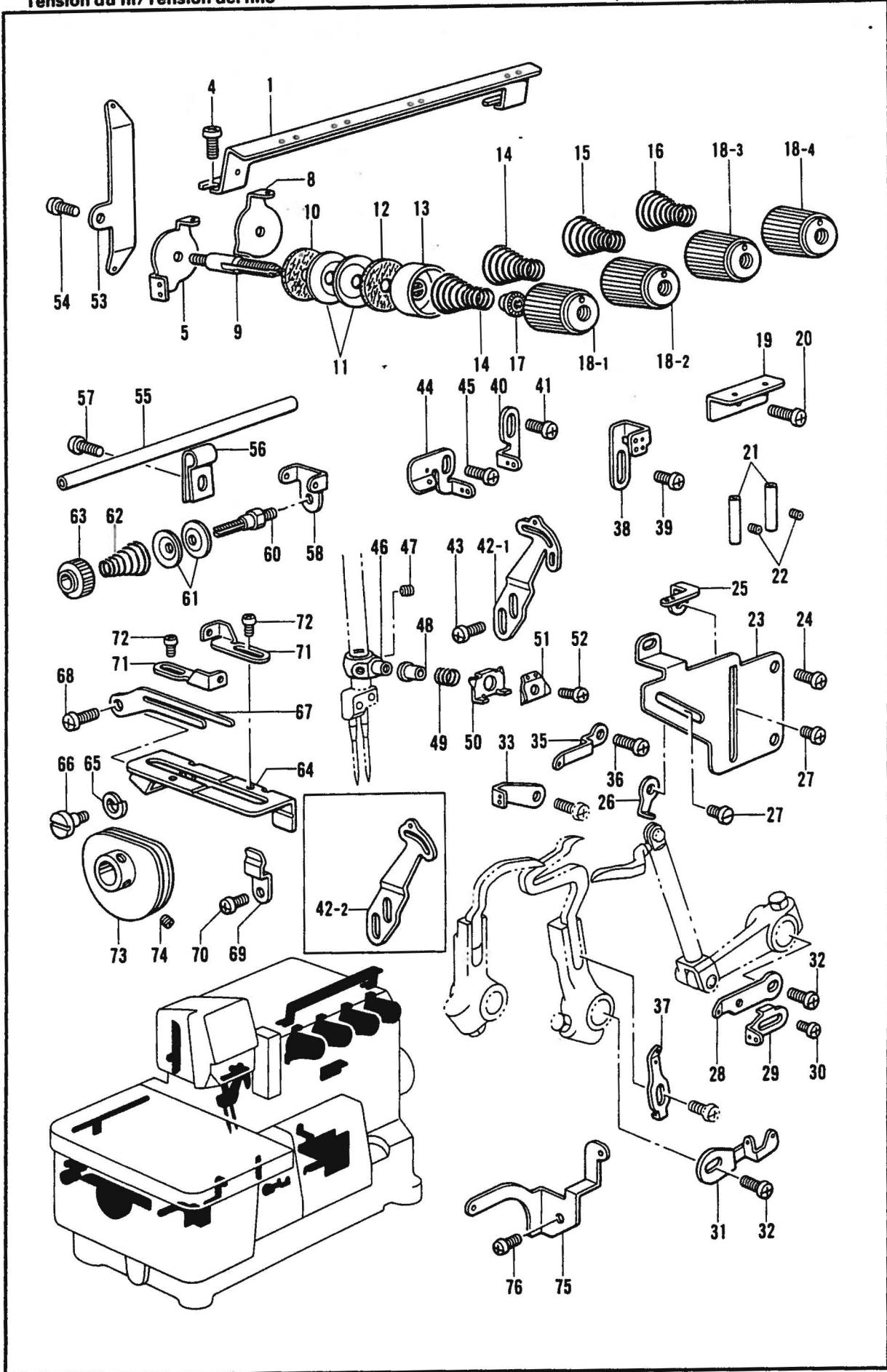
L. 針調子関係 / Thread tension / Fäuerspannung /
