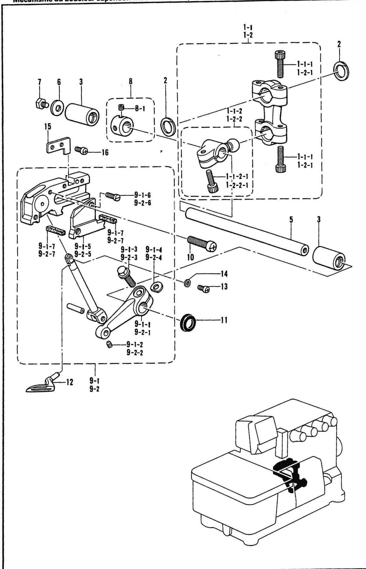
G. 上ルーハー関係 / Over looper mechanism / Mécanisme du boucleur supérieur / Mecanismo del presilladora superior
