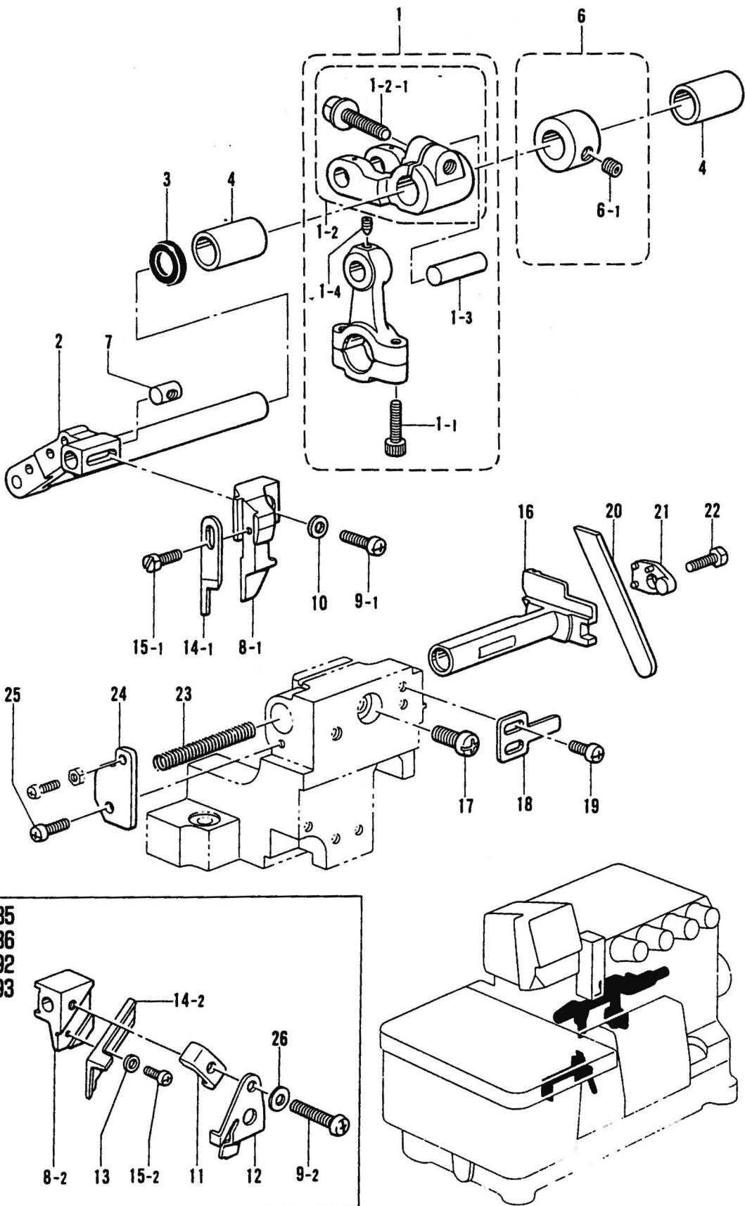
★ 上スヘ・下スヘ機構 / Knive mechanism / Mecanismo del cuchilla
